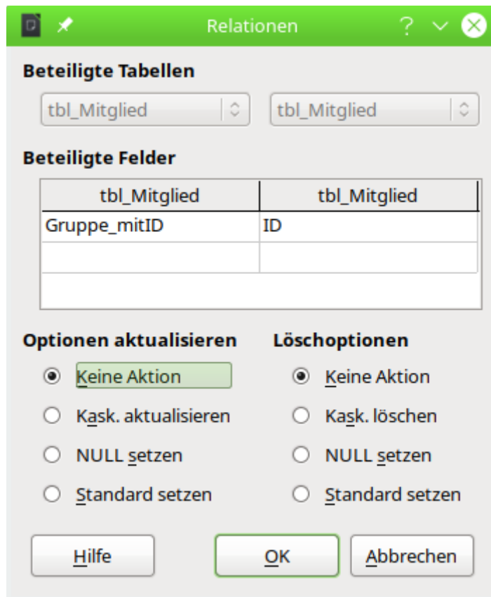
Abbildung 1: Die Beziehung ist so geregelt, dass weder eine Aktualisierung noch eine Löschung eines Mitglieds möglich ist, das mit anderen Mitgliedern über "Gruppe_mitID" verbunden ist.
