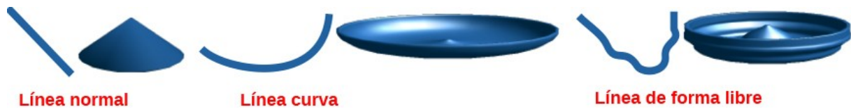
Figura 185: Conversión usando la herramienta En cuerpo de giro 3D (eje predeterminado)
