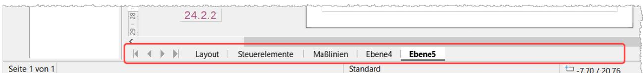
Abbildung 2: Ebenenleiste unterhalb des Arbeitsbereichs
