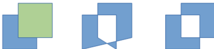
Abbildung 7: Verbinden und zum Vergleich Kombinieren (rechts)
