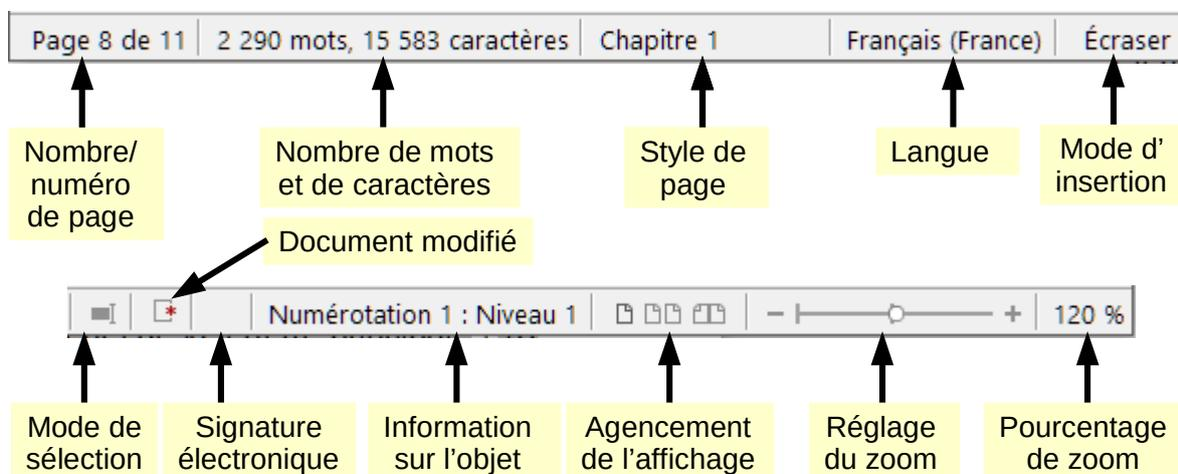
Figure 6 : Exemple de barre d'état de Writer
